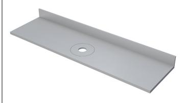
**5** Aplique adesivo PU ao redor de toda a borda de maneira uniforme para realizar a adequada vedação e fixação da cuba ao tampo.
